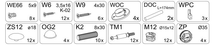
Proszę sprawdzić kompletność okuć przed montażem Bitte überprüfen Sie die Vollständigkeit der Fittings vor der Montage Please check the completeness of the fittings before assembly Пожалуйста, проверьте комплектность фур Prosím zkontrolujte úplnost konektorů před instalací Prosím skontrolujte úplnosť konektorov pred inštaláciou Prije montaže provjerite cjelovitost okova Pre postavljanja proverite kompletnost okova Kérjük, ellenőrizze a szerelvények teljességét a szerelés előtt
