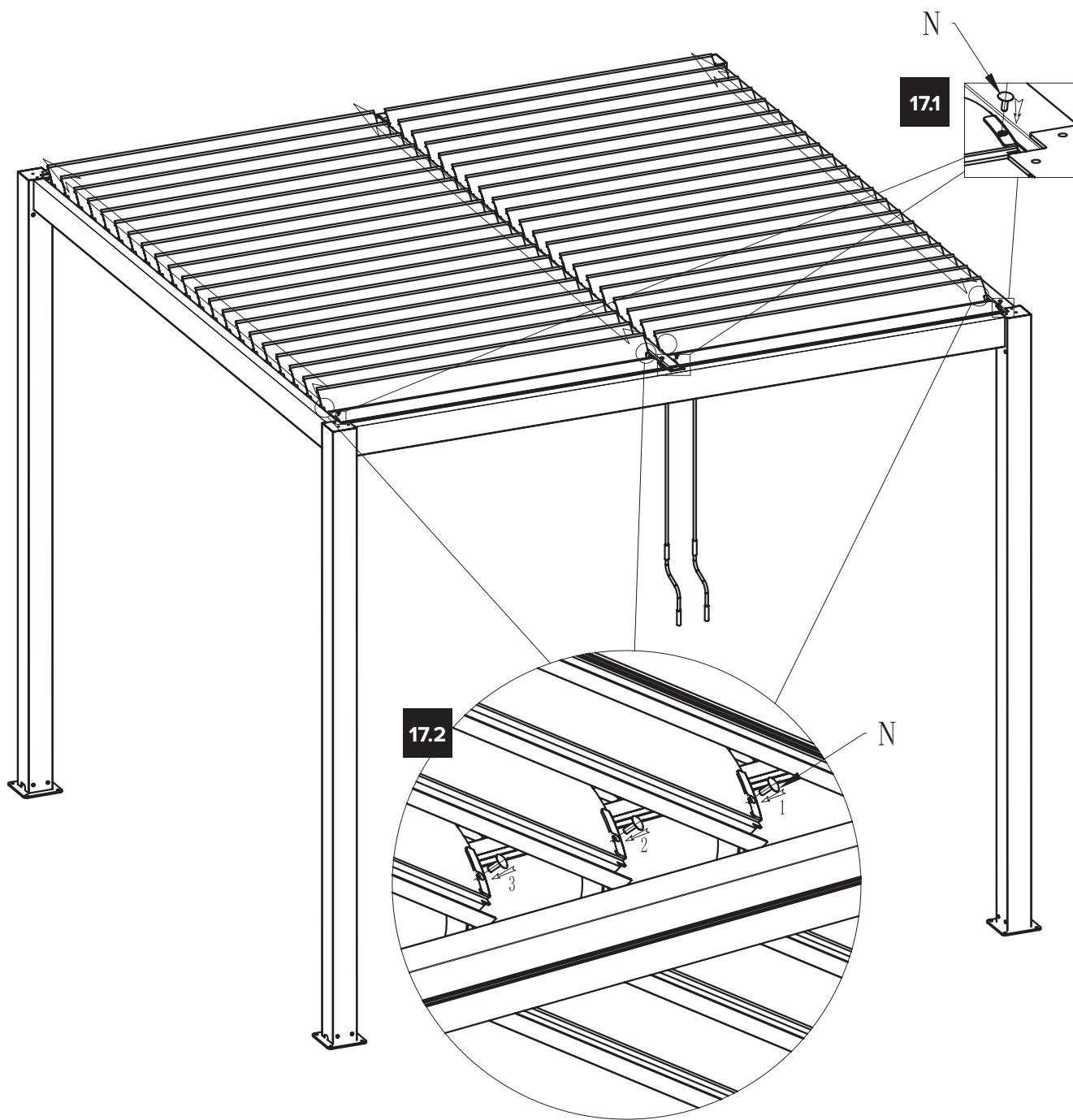
Obróć listwy do połowy, włóż plastikowy kołek (N) kolejno w otwór dwóch końców każdej listwy.
